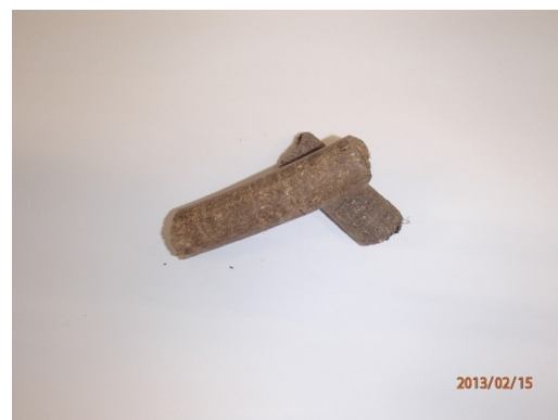
図 3.2-39 刈草 R D F (国土交通省中国地方整備局 中国技術事務所提供)
