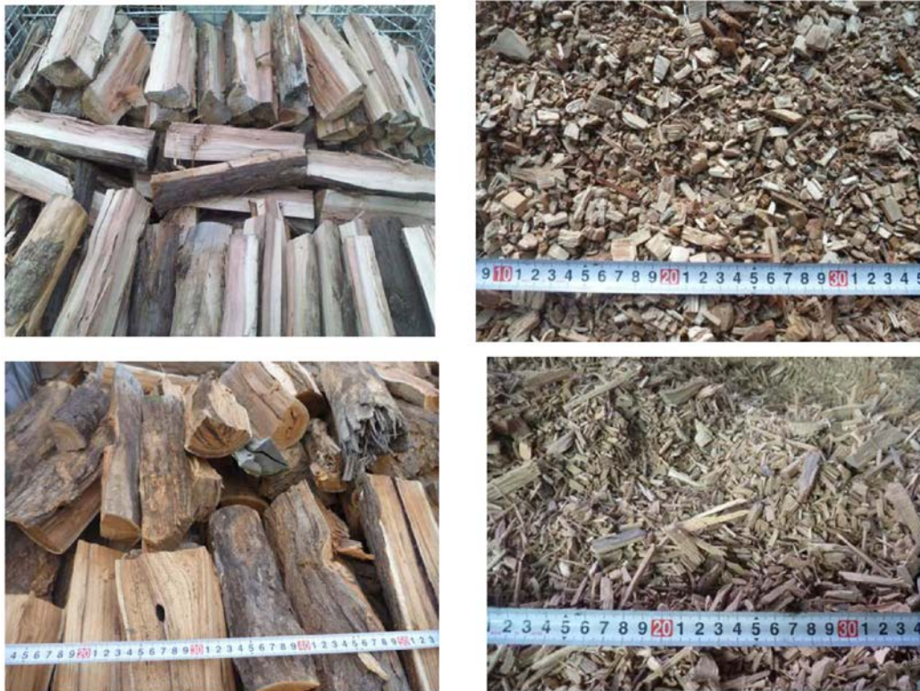
図 3.3-22 ガス化発電実験に使用した原料 上段：スギ 下段：ニセアカシア (ともに左が破碎前、右が破碎後)
