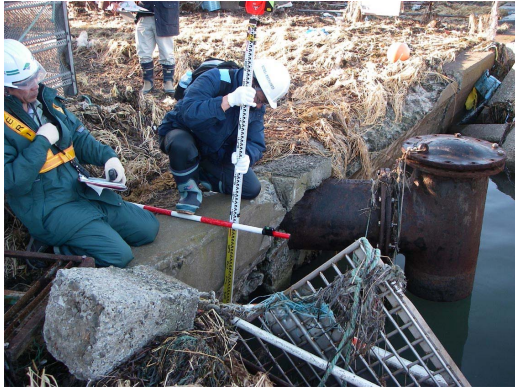
(1) 護岸天端の高さの測定
