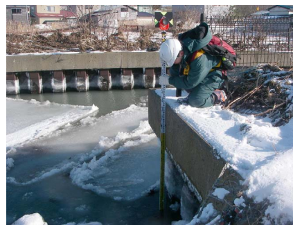
(1) 護岸の天端高の測定
