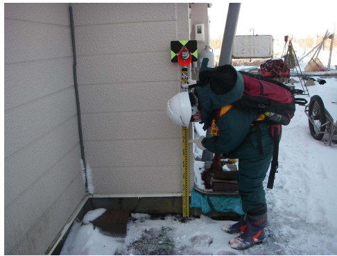
(4) 浸水深の測定 (3)の右側民家の外壁)
