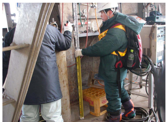
(4) 浸水高の測定 ((3)の右側建物の内部)
