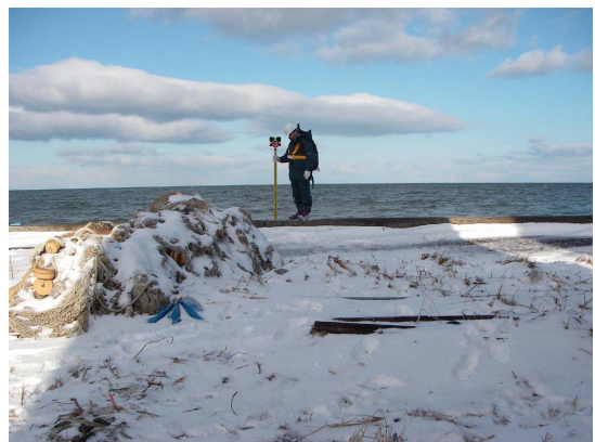
(2) 緩傾斜護岸の天端高の測定
