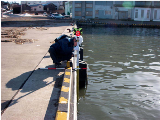
(2) 岸壁天端の高さの測定
