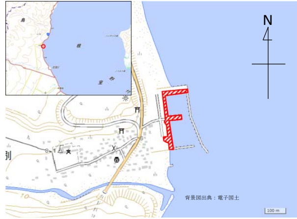
図-2.34 薫別漁港における浸水箇所
