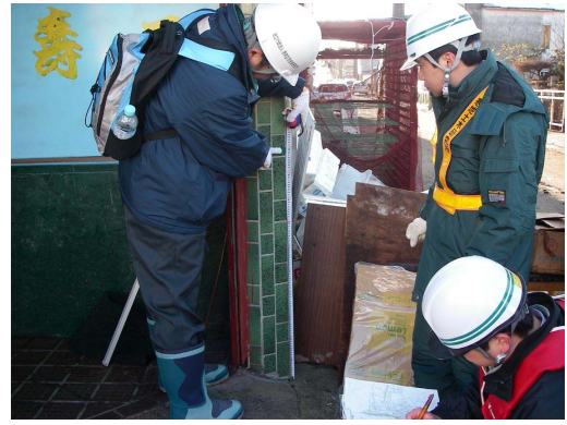
(5) 浸水高の測定 (左側の調査員が指差す位置)
