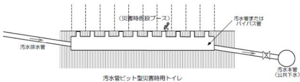
図Ⅲ-27 汚水管兼用トイレ 模式図(例)
