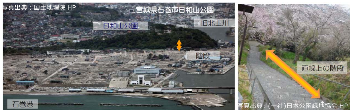
図 I-3 高台への階段が緊急の避難路となり多くの被災者が短時間で避難することができた事例
