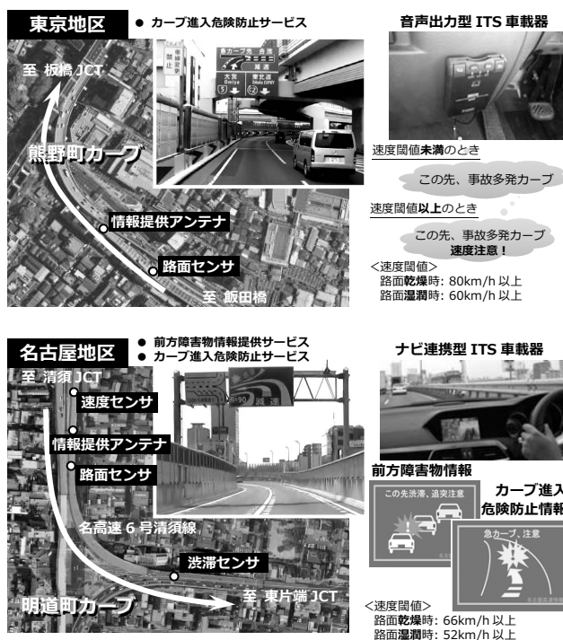
図 1 各地区の機器配置状況と提供サービス内容
