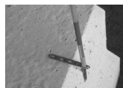
図6 面取り部の誤差を防ぐための治具
