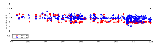
図 5.2 固有振動数 (6F/GL) の経年推移
