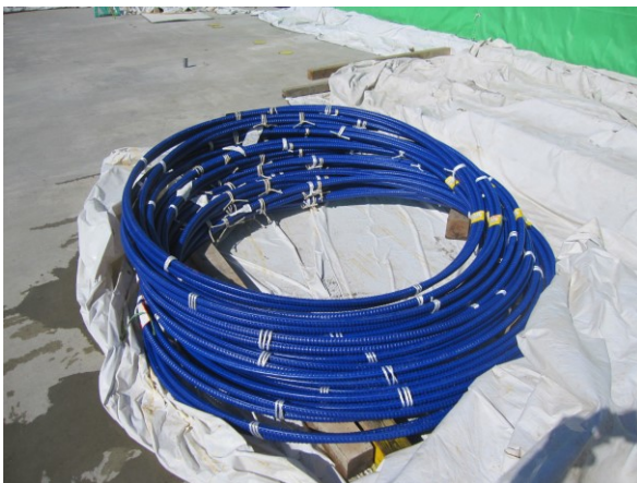
写真-5.1.2 プレグラウト PC 鋼材
