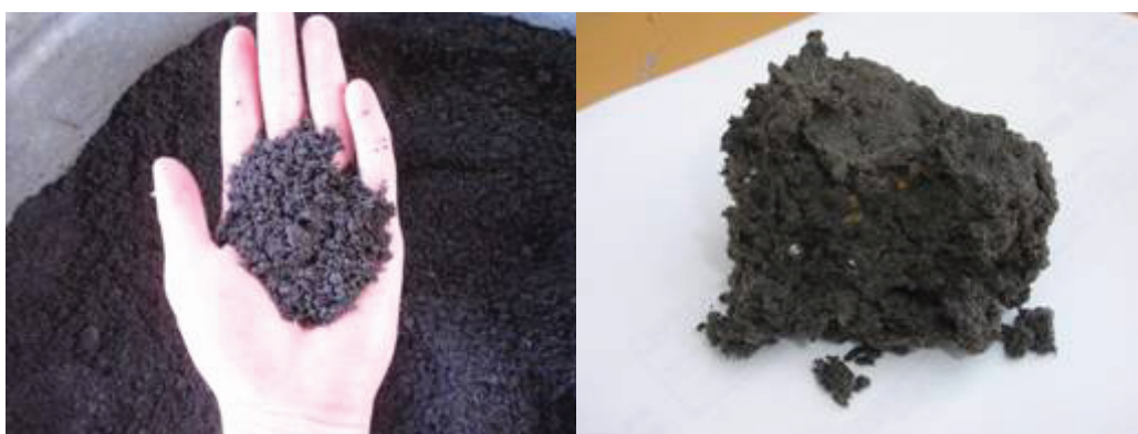
図資料 1-24 本技術の脱水汚泥(左)と従来脱水汚泥(右)
