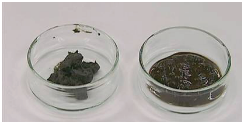
図資料 1-8 水熱処理前後の汚泥の変化 (左：水熱前プレ脱水スラリー 右：水熱処理後)
