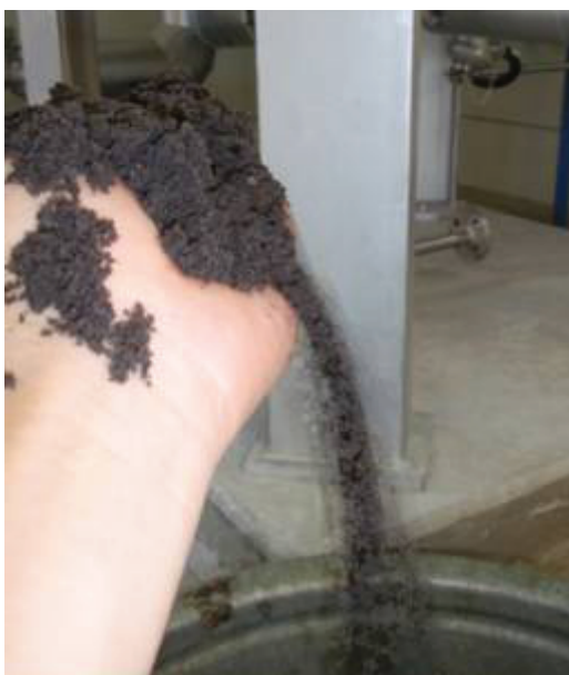
図資料 1-25 本技術の脱水汚泥性状その2
