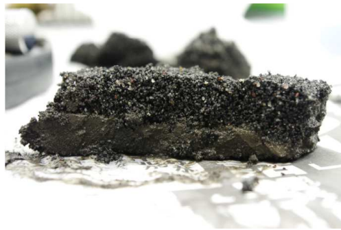
写真 3.3.3 リングせん断試験後の供試体の様子。大きい粒径が上に移動している
