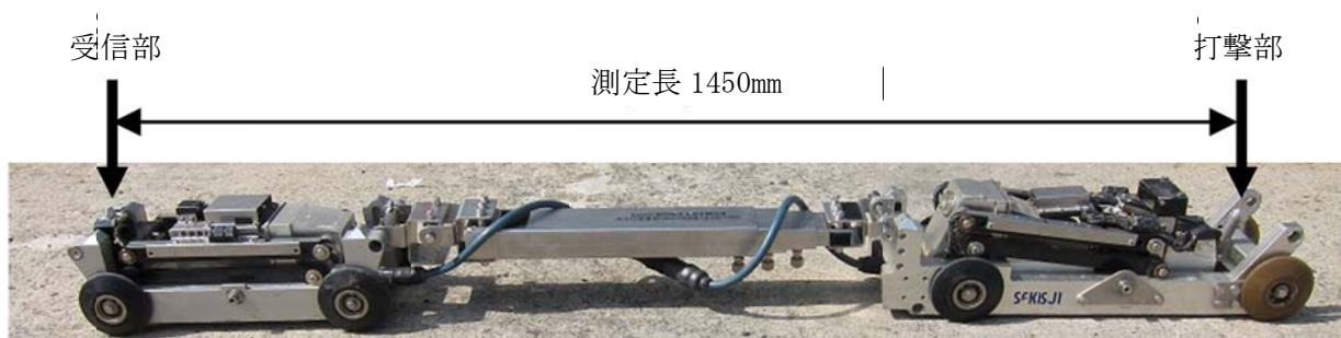
図 2-8 衝撃弾性波検査法装置の外観
