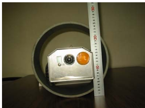
写真 3-6 自走台車 (管壁との隙間)
