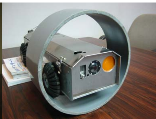
写真 3-7 自走台車 (管内設置状況)
