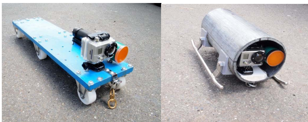
写真 4-3 イエローケーブル押し込み方式試作機
