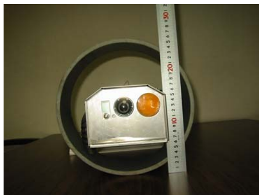
写真 3-6 自走台車 (管壁との隙間)
