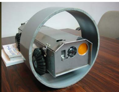
写真 3-7 自走台車 (管内設置状況)
