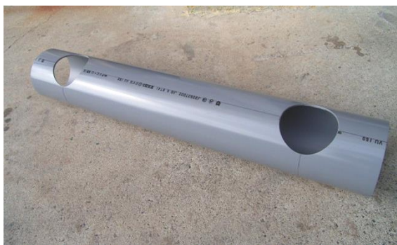
図 3-33 塩化ビニル管 VU150（穿孔後）
