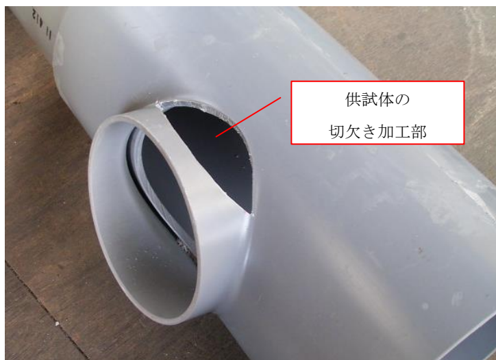
図 3-37 取付管角度 45 度位置での載荷を行う供試体の加工
