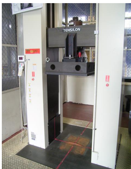
図 3-40 鉄筋コンクリート管に使用する、テンシロン圧縮試験機 (300 k N)
