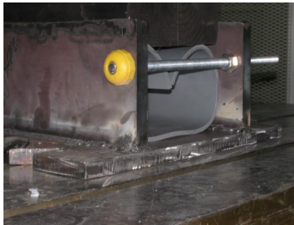
図 3-8 Case39 たわみ率 33%の試験状況
