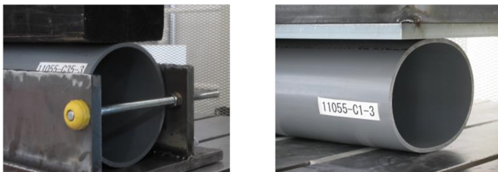
図 3-2 管体拘束条件（左図）、管体非拘束条件（右図）
