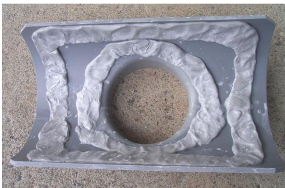
図 3-35 支管へのエポキシ樹脂接合剤塗布
