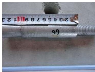
写真-3.2.20 切断後のスリーブ長 (M24)
