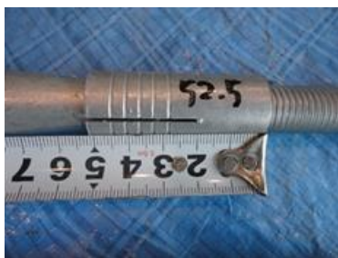
写真-3.2.19 切断後のスリーブ長 (M16)
