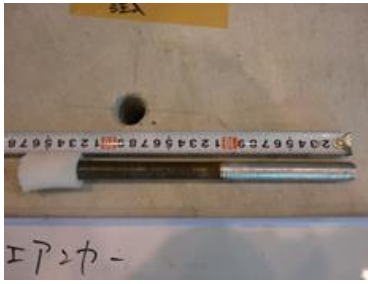
写真-3.2.3 75%充填用ボルト
