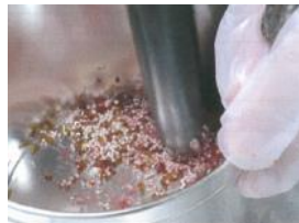
写真-3.2.9 樹脂攪拌状況（加水）
