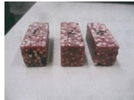
写真-3.2.10 供試体（圧縮試験前）
