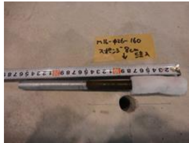
写真-3.2.4 50%充填用ボルト
