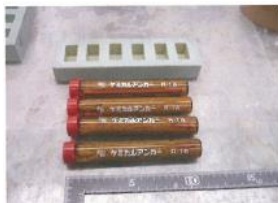
写真-3.2.8 試験用樹脂アンカー
