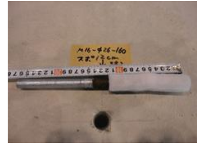
写真-3.2.5 25%充填用ボルト
