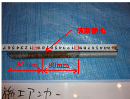
写真-3.2.1 破断ボルト（全景）
