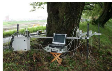
γ線樹木診断機による腐朽診断
