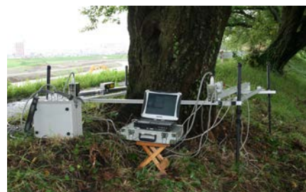
\gamma 線樹木診断機による腐朽診断
