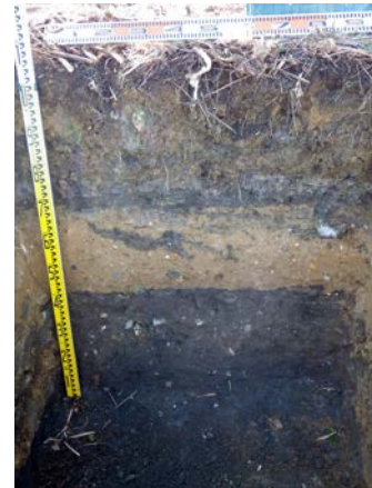
隣接地の土壌断面 (埋立土壌が固結)
