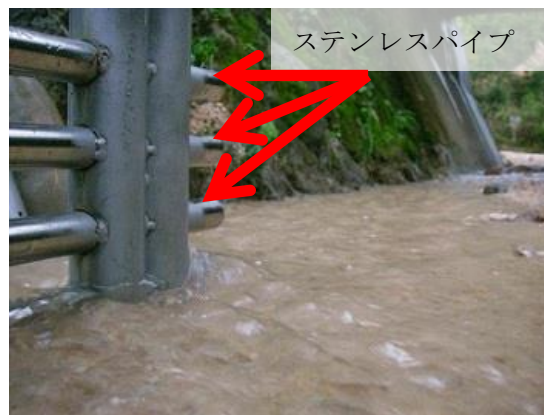
図 4.1.4 多段式浮遊砂採取装置 (白水谷流砂観測所) 複数の深度で採水する 2)
