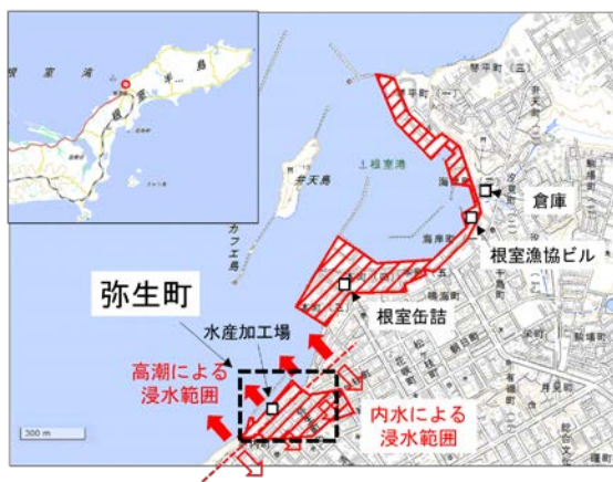
図-2.5 浸水状況図（根室港内：弥生町） （電子国土より）
