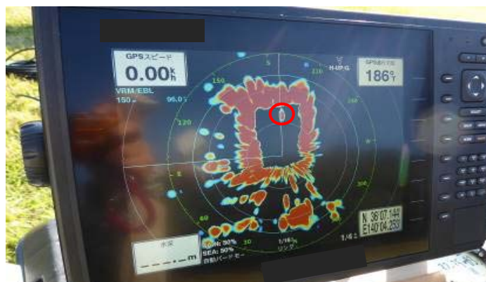
写真 2-4-3 レーダーによるドローンの確認状況（赤丸内がドローン）
