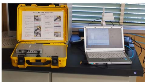
写真 2-2-1 GPS-TX の電波を受信するための基地局（受信機、アンテナ）と設置状況 左側写真：黄色のケースに入った受信機と記録・可視化のための PC、右側写真：伸縮ポールでできたアンテナ
