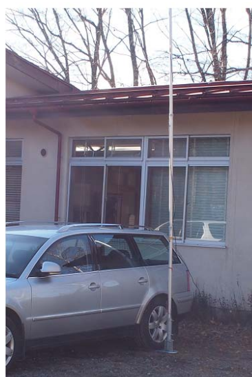
写真 2-2-1 GPS-TX の電波を受信するための基地局（受信機、アンテナ）と設置状況 左側写真：黄色のケースに入った受信機と記録・可視化のための PC、右側写真：伸縮ポールでできたアンテナ
