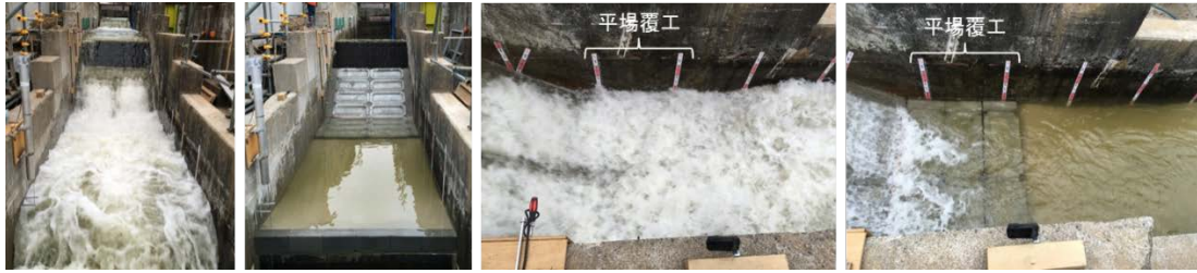
写真-13 平場ありののり尻周辺の流況・洗掘状況（越流水深 30cm）
