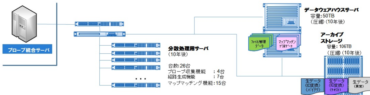
図2 交通データシステムの構成
