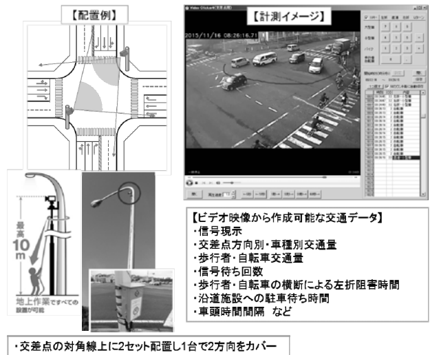
図-2 高所ビデオ撮影装置を使用した現地観測例
