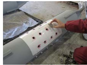
写真2 感圧紙による接触圧測定
