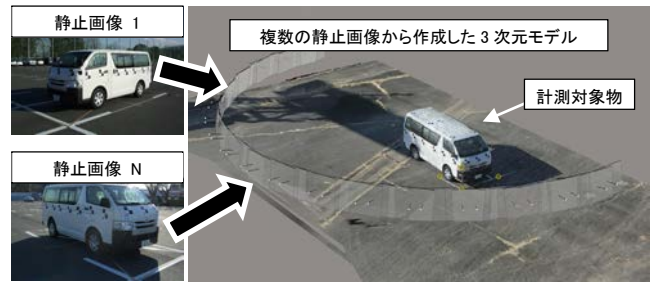
図-6 複数の静止画像を用いた 3 次元モデル作成
