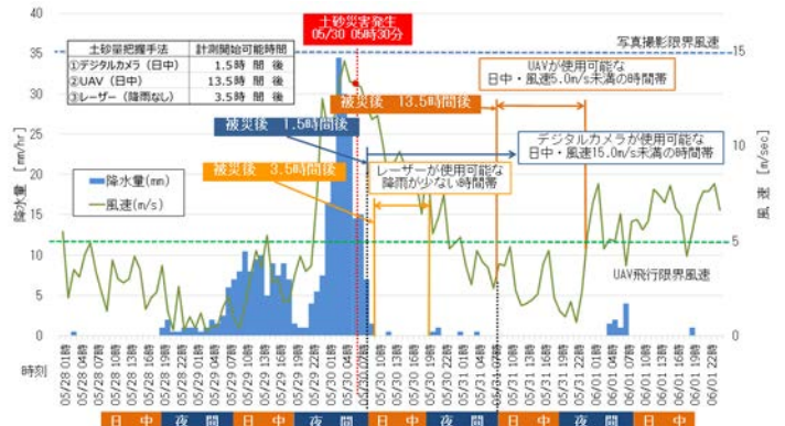
図-5 土砂災害発生時の各手法の活用可能時刻の例
