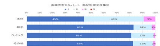
図-4 部材別健全度(大型カルバート)
