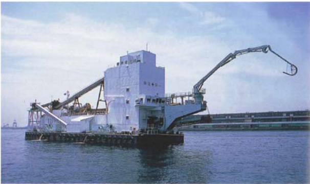
写真-A.10 コンクリートミキサー船 2)
