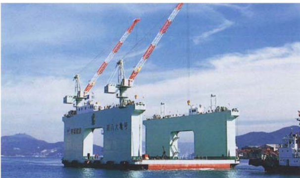
写真-A.11 ケーソン製作用作業台船 2)
