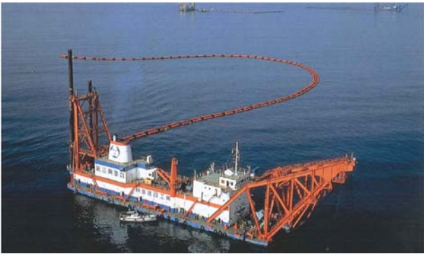
写真-A.2 ポンプ浚渫船 2)
