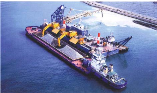
写真-A.4 揚土船 (リクレーマ船) 2)
