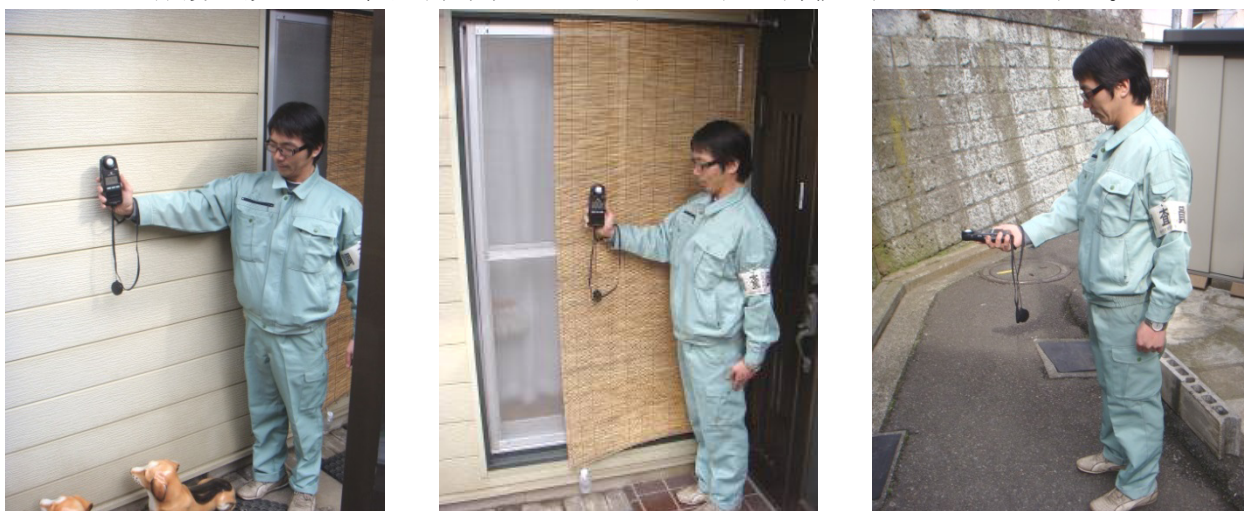
図 2-8 照度の測定イメージ (左から、建物外壁、開口部、道路面)
