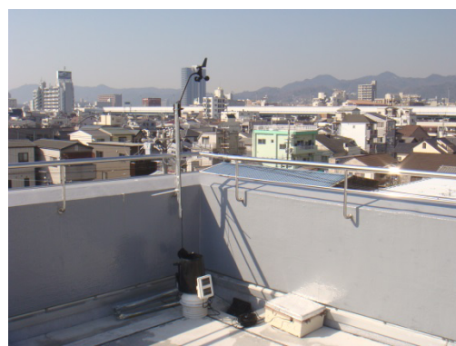
図 2-10 屋上における上空風の風速分布の測定イメージ
