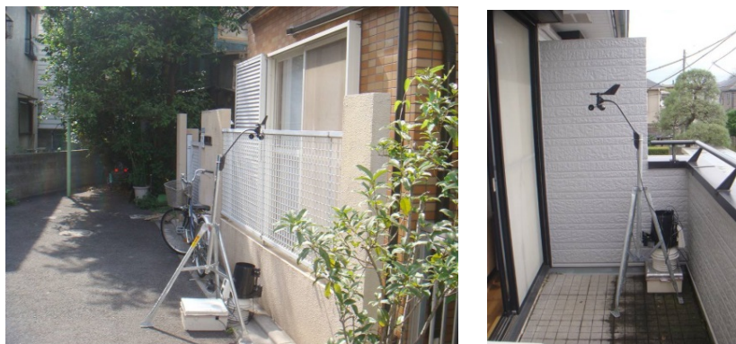
図 2-11 開口部近傍の風速分布の測定イメージ
