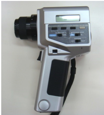
図 2-20 輝度計 (KONIKA MINOLTA 社 型番：LS-110)
