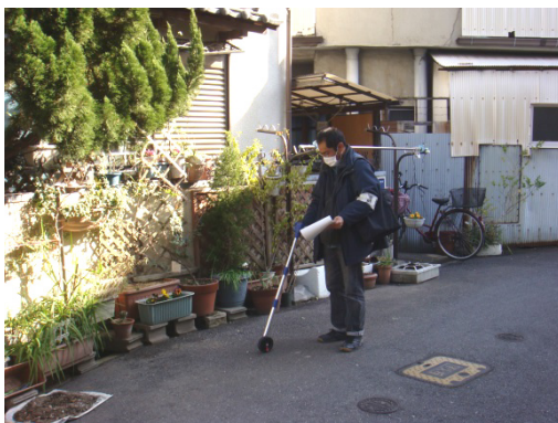
図 2-13 道路幅員の測定状況
