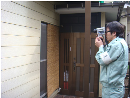
図 2-22 反射率測定状況 (左：外壁面、右：道路面)
