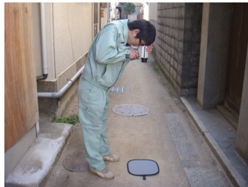
図 2-22 反射率測定状況 (左：外壁面、右：道路面)
