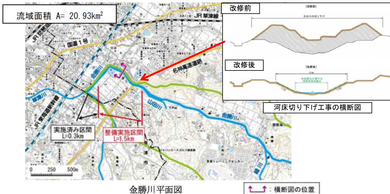
図-3.2.3 金勝川の改修計画平面図 18)
