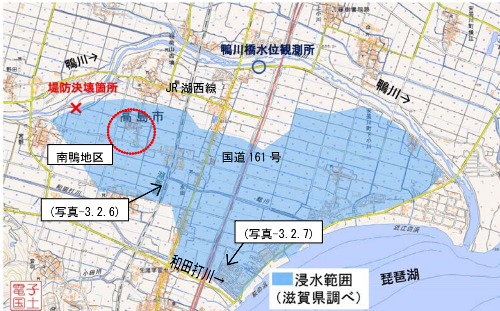
図-3.2.9 鴨川における浸水範囲 (滋賀県提供の浸水調査結果をもとに作成)
