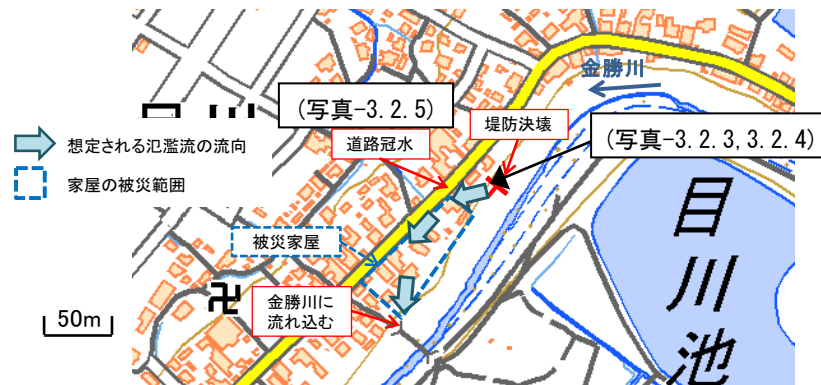
図-3.2.5 金勝川目川地区における氾濫流の状況
