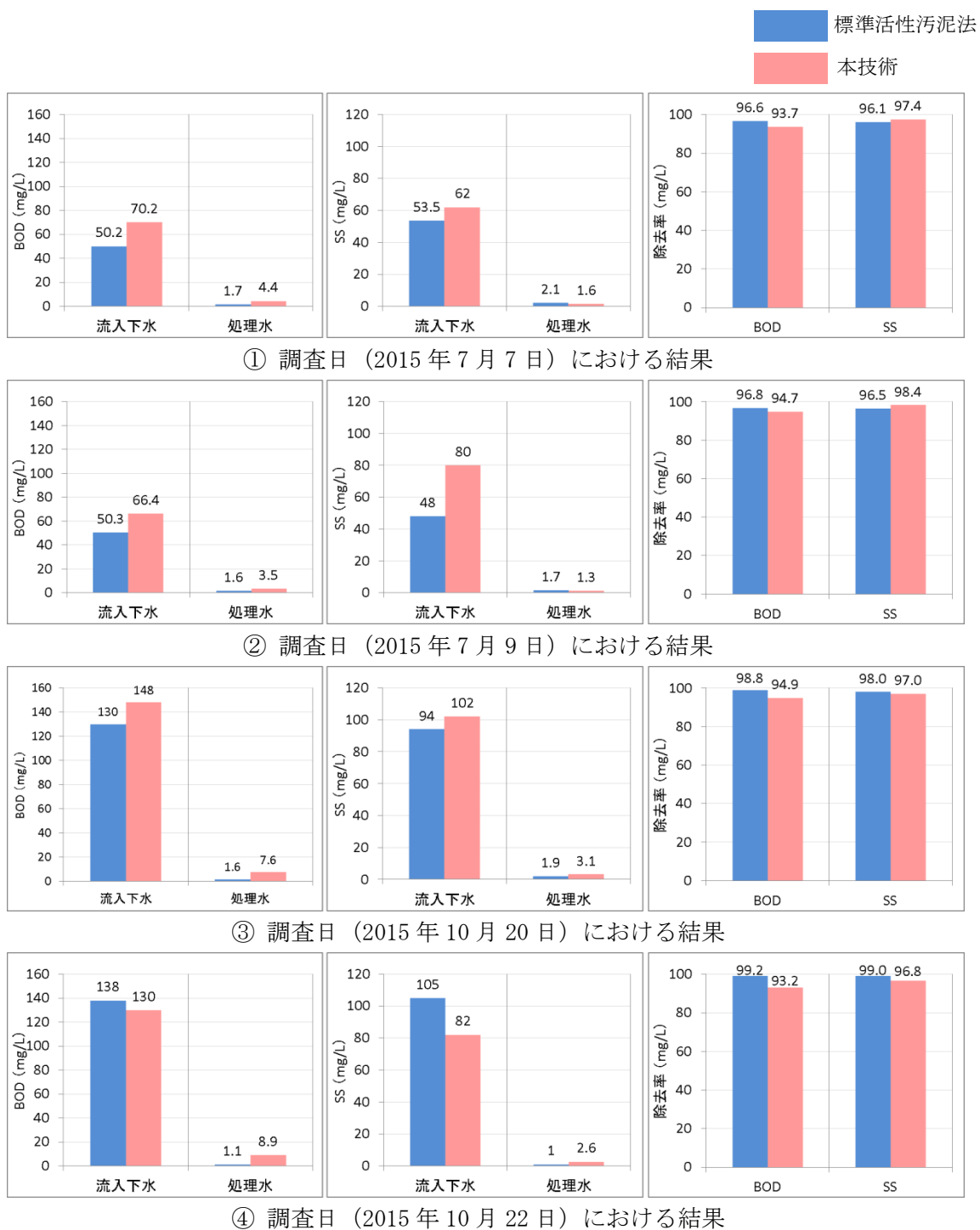
図資 1.14.1 既設の標準活性汚泥法施設と本技術の処理水質比較
