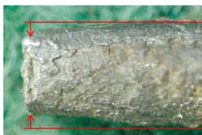
引張り破壊により破断したPC鋼線の形状 (絞り切り形状となる)
