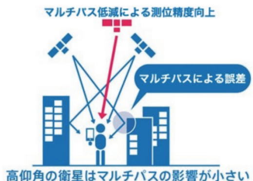
図 5-1 マルチパスによる測位精度低下 6)
