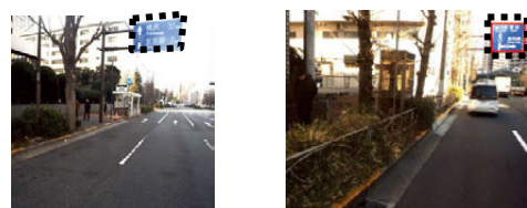
図-2 連続画像データより道路案内標識を抽出した例
