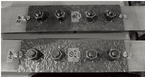
写真-1 すべり試験片
