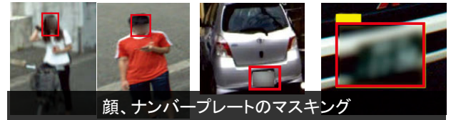
図-2 顔やナンバープレートのマスキング処理
