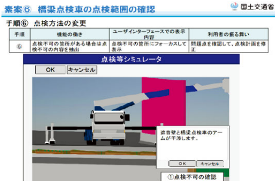
図-1 点検シミュレーションの適用事例のプロトタイプ一部の画面（点検車両の干渉確認）
