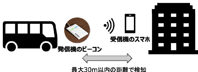
図-3 発信機×受信機間の BLE 信号送受信による走行実態調査のイメージ
