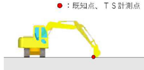
図-4.11 バケット位置精度の標準的な確認方法 27)
