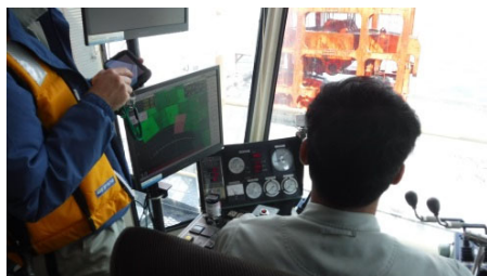
図-4.16 浚渫施工管理システム使用例 1
