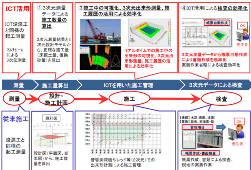
図-2.6 ICT 海上地盤改良工 実施イメージ図 13)
