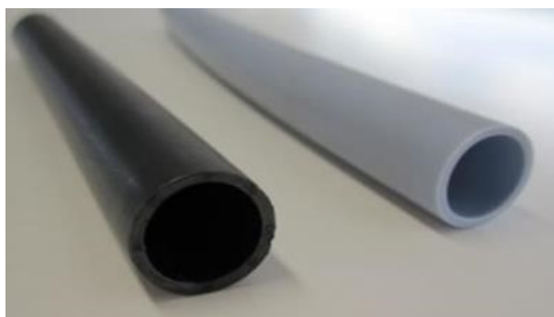
写真 2-2 左：高熱性能採熱管、右：一般採熱管
