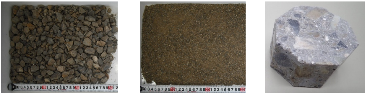
写真 2-1 珪石・珪砂および高熱性能コンクリート舗装
