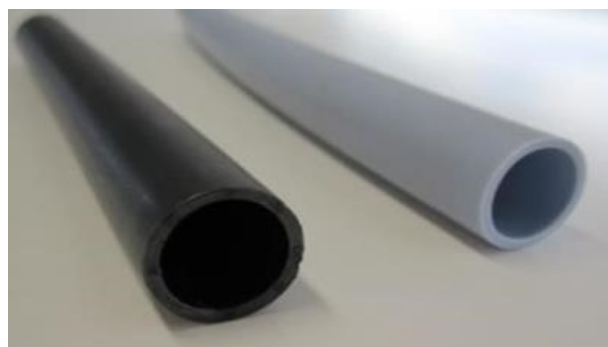
写真 2-2 左：高熱性能採熱管、右：一般採熱管
