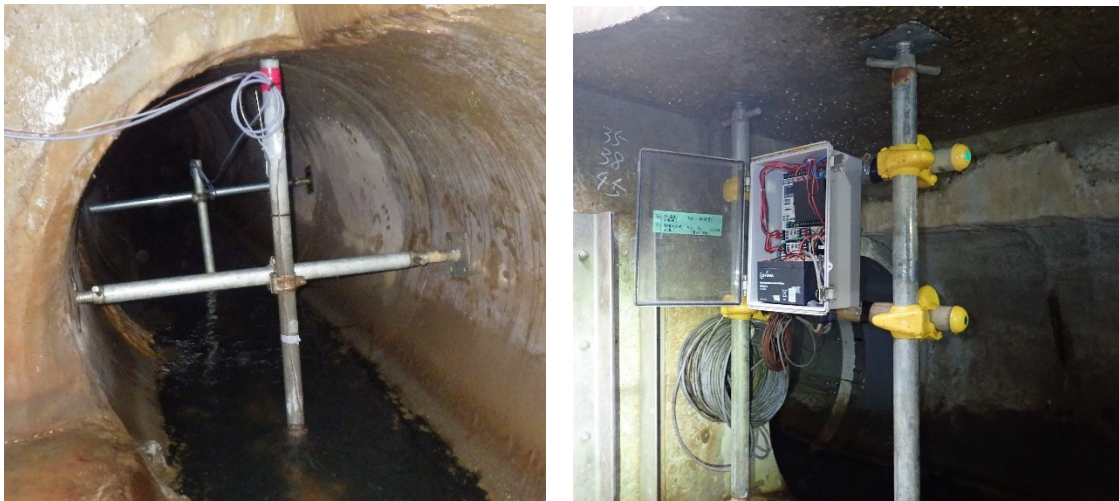
写真 3-1 下水温度・水深の調査実施例（左：水深計・水温計、右：データロガー）
