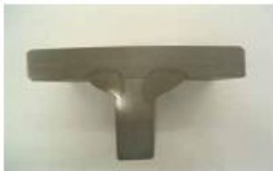
写真-1-1 マクロ試験結果（直ウェブ）
