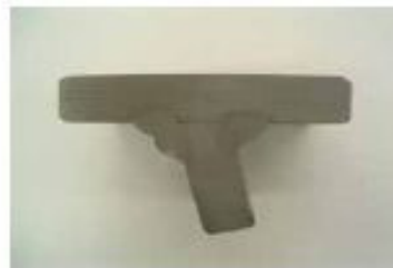
写真-1-2 マクロ試験結果（斜めウェブ）
