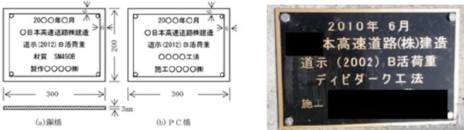
図-1 橋歴板（アルミニウム板）の例
