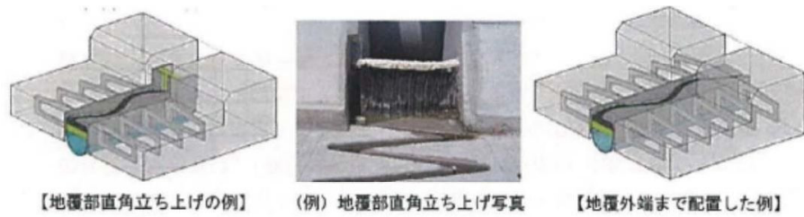
図-4 伸縮装置の端部処理の例
