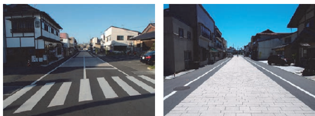
写真-3 イメージ狭さくが採用された事例 (左：Before、右：After)【平泉町中尊寺通り】
