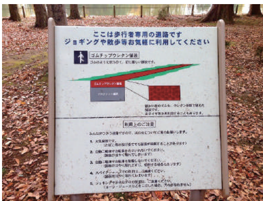
ゴムチップウレタン舗装の構造
