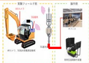
例：土工フィールドを活用した遠隔操作性能検証試験
