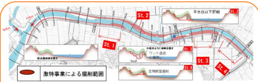
河川事務所での活用 (河道の応答特性を踏まえた掘削範囲の設定例)
