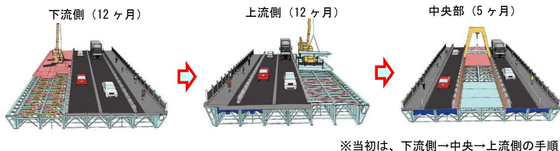
図-3-1 淀川大橋床版取替の施工手順
