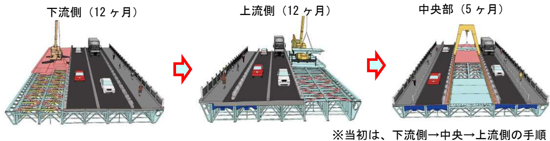
図 参 1-5 採用した施工手順
