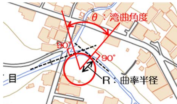
図 2-2 曲率半径、湾曲角度の求め方 10) に加筆
