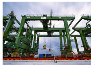
図-5 Tuas に納品された遠隔操作 RTG
