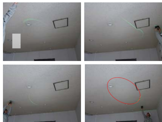
水平レーザーによる確認状況 ※天井面から水平レーザー照射面までは15mm
