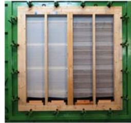
出典:(一財)建材試験センター 試験法:JIS A 1517(建具の水密性試験方法)
