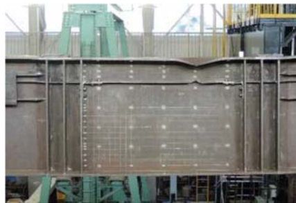
図 1-1 補強した既設鋼桁を模擬した載荷実験
