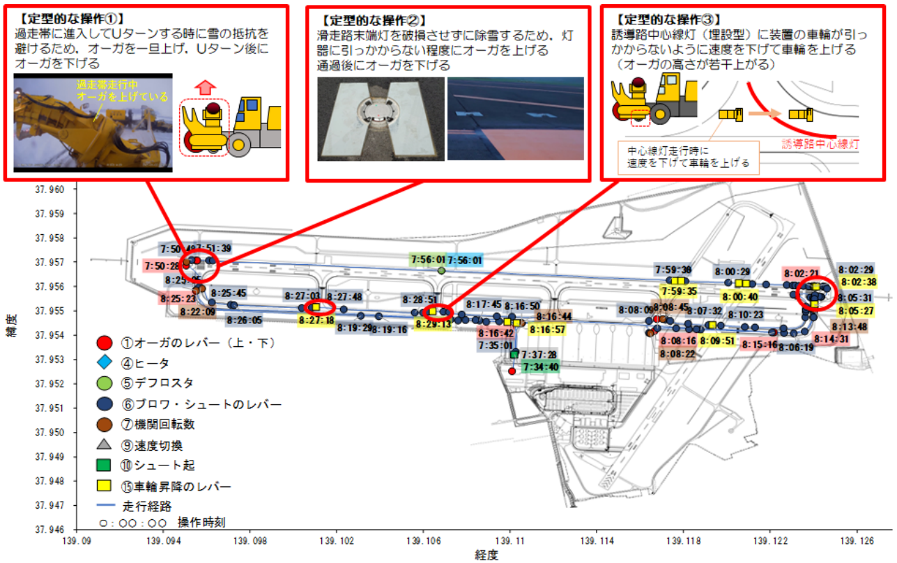
図-32 操作の整理結果例 (ロータリ: 2021/1/2 7:30-8:40)
