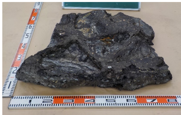
写真-6 現地防波堤の採取Asマット塊（和歌山港）
