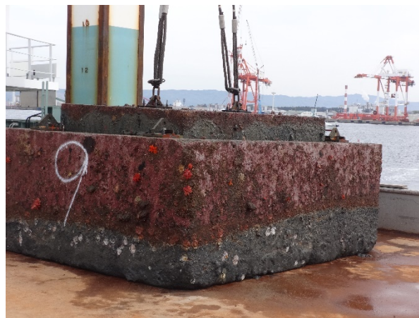
写真-3 試験片を保管するコンクリート製函（和歌山港）
